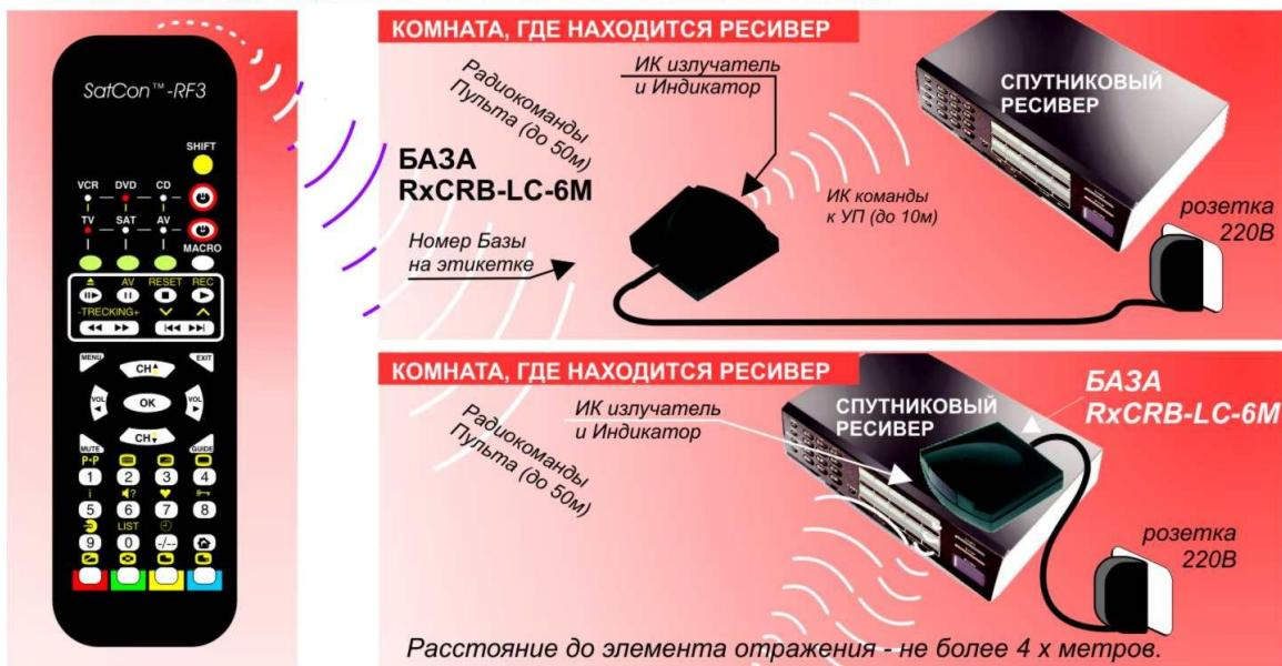
Рис. 1. Управление спутниковым ресивером при помощи системы Satcon RF
