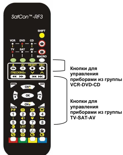
Большинство кнопок могут посылать прибору две команды: Основную и Дополнительную. Наличие Дополнительной функции обозначается над кнопкой или на кнопке желтым цветом. Чтобы использовать Дополнительную функцию кнопки, необходимо последовательно нажать желтую кнопку SHIFT, а затем выбранную кнопку. Т.е. *каждую кнопку Радиопульта можно обучить ДВУМ командам «родного» пульта управляемого Прибора.*
