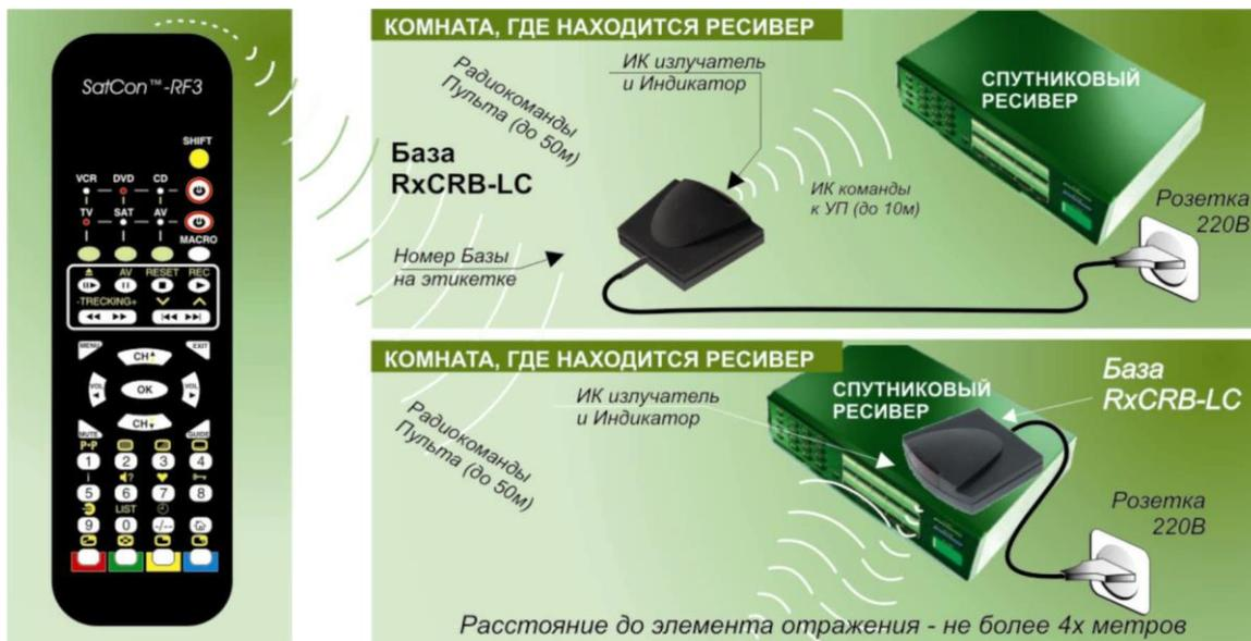
На рисунке показан пример управления спутниковым Ресивером. При нажатии кнопки на Радиопульте излучается радиокomанда, которая принимается Базой. При правильном приеме База излучает через ИК - излучатель соответствующую ИК команду Ресиверу. При этом слабо светящийся Индикатор
